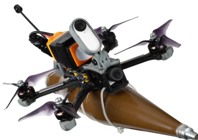
Ryc. 2. Dron FPV wraz z ładunkiem wybuchowym (Biliński, 2024).
