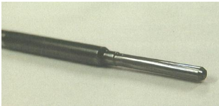
Ryc. 6. Trzpień (foremnik) do wykonania gwintu lufy metodą kucia (FB, 2025).
