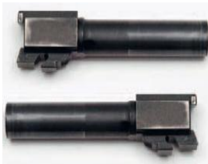
Ryc. 10. Badane lufy pistoletów samopowtarzalnych Walther P99 - u góry widoczna bruzdowana przepychaniem, u dołu – obkuwaniem (FB, 2025).
