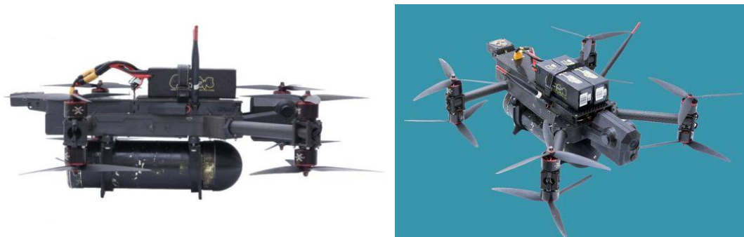
Ryc. 3. Przyjęty na uzbrojenie wojska ukraińskiego dron produkcji ukraińskiej SkyKnight 2 z podczepionym granatem 40 [mm] o masie 2,5 [kg] do którego budowy użyto niektóre komponenty stosowane w dronach cywilnych, (Altair, 2023; Belsat, 2025).
